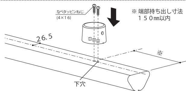
端部持ち出し寸法を決定の上、手すり棒にφ2.8程度の下穴をあけ、付属のタッピンねじ(4×16)を使用して3面付ソケット固定します。
